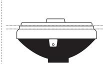
最後に内リムと外リムをマウントすれば完成です。 ※ランプユニットの光軸調整のため、マウントボルトのナッ トは緩み止ナットになっています。 マウントボルトの締めすぎに注意してください。強く締め
