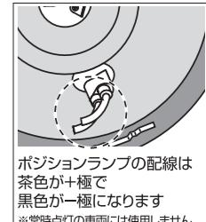
注1)ランプを車体に取り付ける際に、電球周りのダストブーツを必ず装着してください
