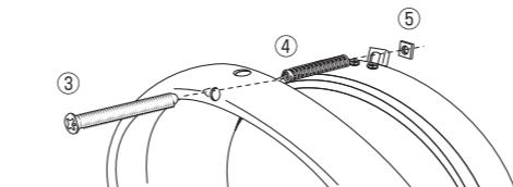
光軸調整ボルトの取付が終わったら、外リムとのマウントの前に、ランプユニットと外リムを概ね平行になるまで光軸調整ボルトを調整してください。
